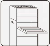
Langkah 2: lepaskan filter yang akan diganti dan pasang yang baru
